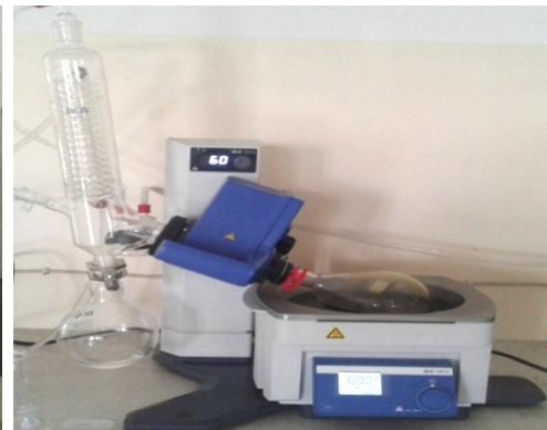
Proses Ekstraksi Daun Jambu Air Dengan Menggunakan Rotary Evaporator
