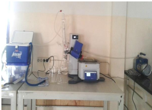
Proses Ekstraksi Daun Jambu Air Dengan Menggunakan Rotary Evaporator
