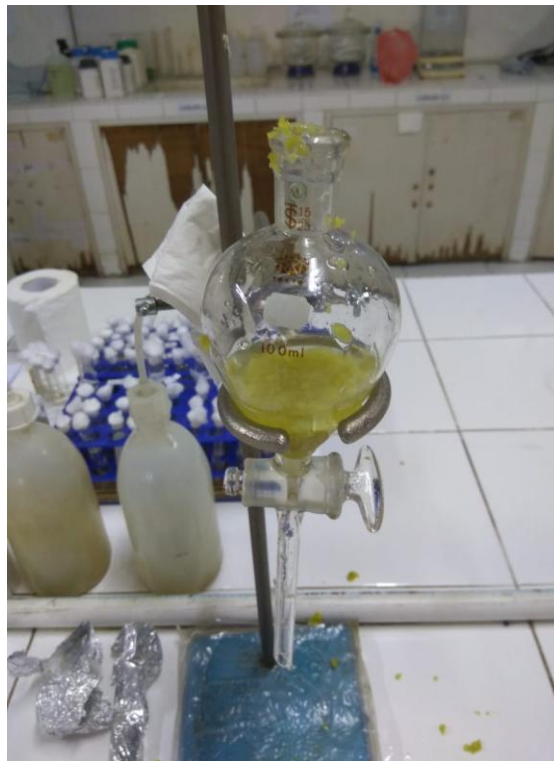
Gambar 8. Penyaringan Klorofom Pada Corong Pisah
