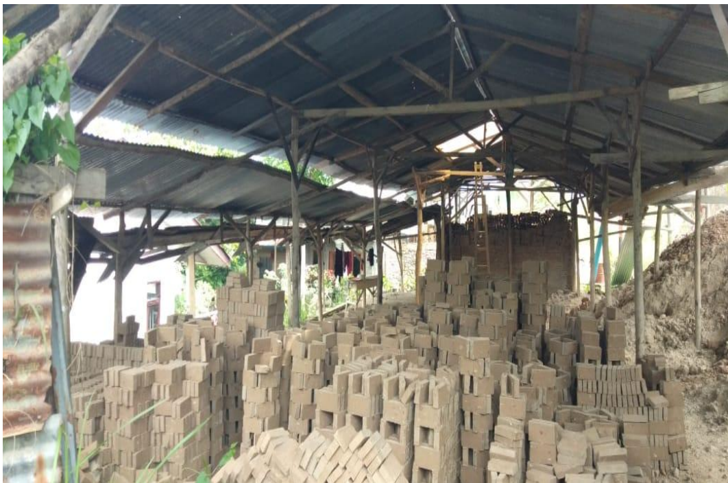
Gambar 13. Hasil Pencetakan batu bata sebelum di bakar
