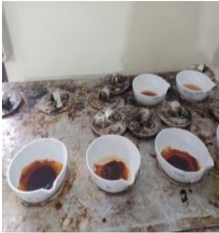
Uji Reaksi Sublimasi di Panaskan di penangas air
