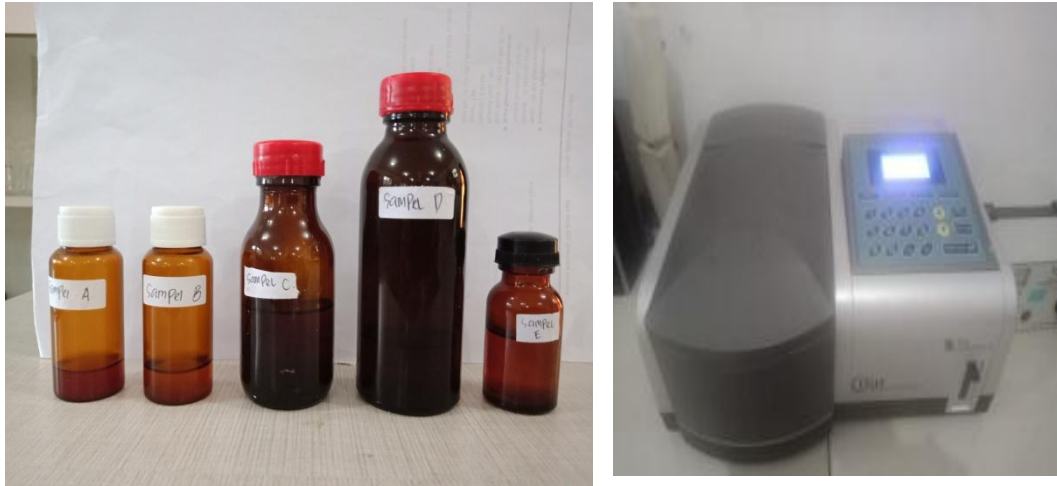
Sampel A, B, C, D dan E yang akan di uji Dengan alat Spektrofotometri UV-VIS T60
