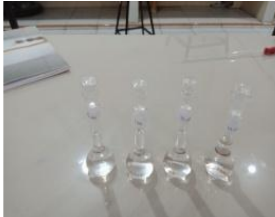
Uji kuantitatif Baku Induk Natrium Benzoat Spektrofotometri UV-VIS T60
