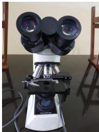
Mikroskop (alat yang dipakai untuk mendapatkan hasil uji sublimasi)
