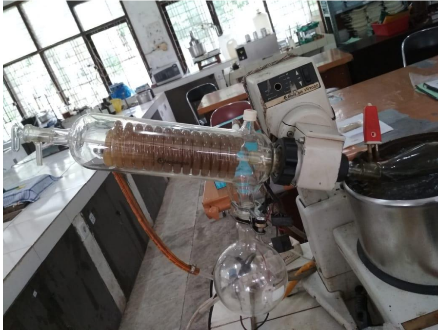
Gambar Proses pembuatan ekstrak rimpang kunyit putih dengan rotary evaporator.
