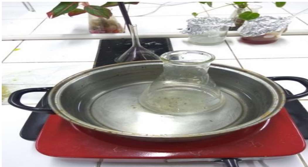
Gambar 8. Hasil penyaringan kloroform dikeringkan diatas penangas air
