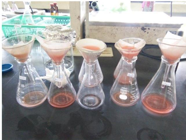
Gambar 3.7. proses penyaringan sampel
