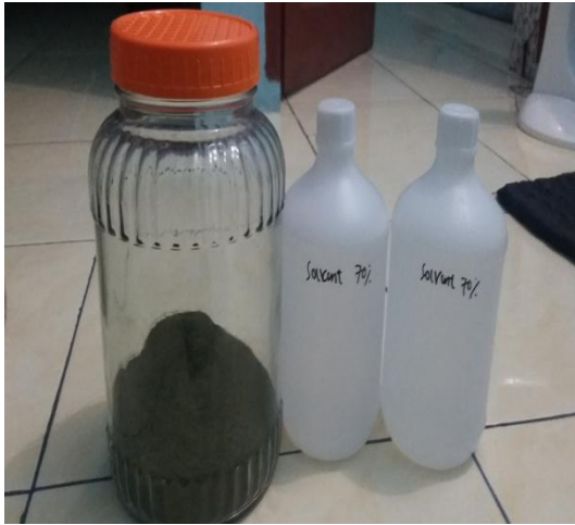
a. Serbuk daun sirih merah dimasukkan dalam toples dan etanol 70 %
