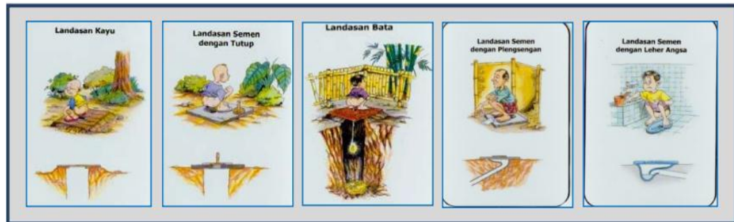
Gambar 2.3. Contoh Bangunan Jamban
