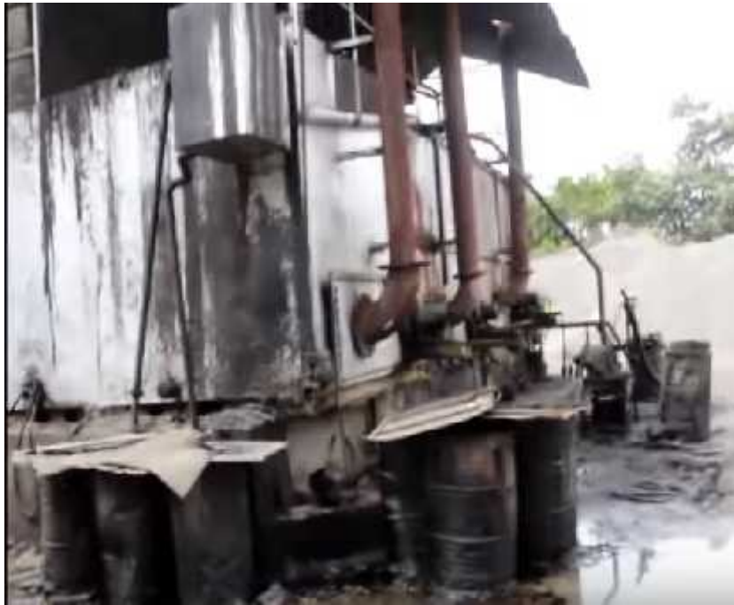
Gambar 9. Tempat pencampuran ter panas dan batu
